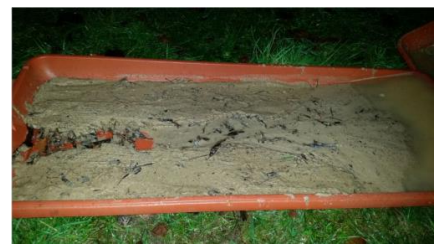
Abb. 1: Beispiel zu Erosion und Deltabildung (Durchgeführt im Szenario 2 mit Blumenkastenuntersetzern)
