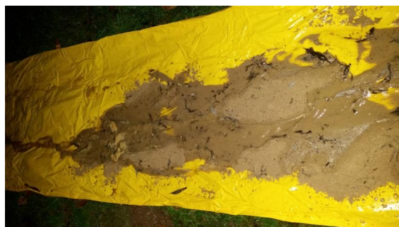
Abb. 2: Beispiel zu Umlagerung und Verzweigung (Durchgeführt im Szenario 2 mit Plane)
