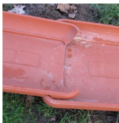
Abb. 1: Beispiel zu Erosion und Deltabildung (Durchgeführt im Szenario 2 mit Blumenkastenuntersetzern)
